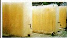
6 「かどぼし」「乾燥」粘着をさけながら、さばき作業を続け、約2mにも伸ばします。伸ばし切った麺を天日で乾燥させます。
